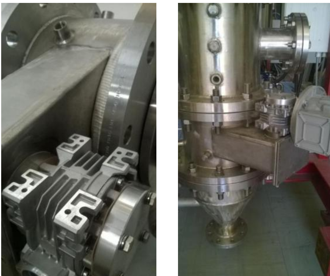
Figura 6. Nuova griglia mobile assemblata sull'impianto GESSYCA
