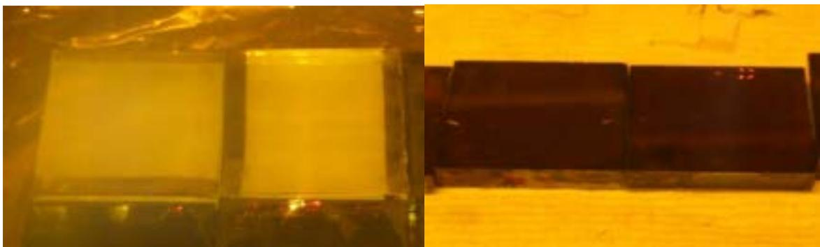
Figura 8. A sinistra i campioni con ZnO sui quali non è avvenuta la cristallizzazione della perovskite. A destra i campioni su TiO<sub>2</sub> con il film di perovskite formatosi in modo uniforme.
