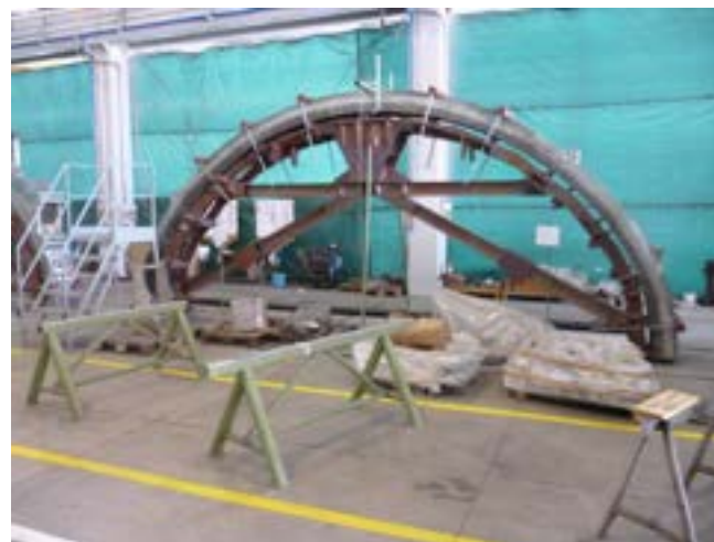
3° gamba curva in fase di assemblaggio
