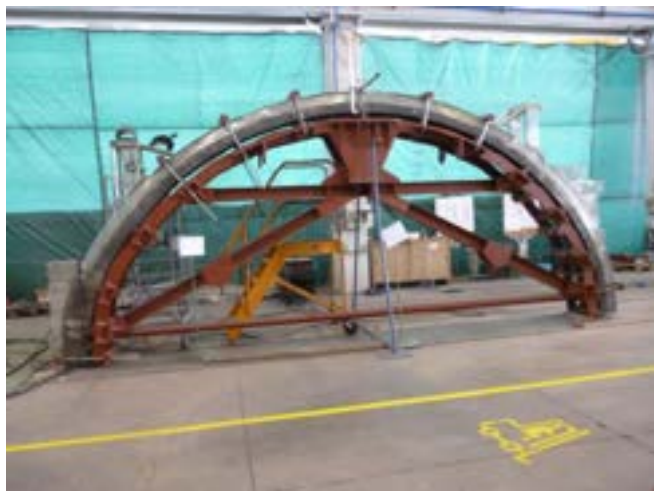
2° gamba curva in lavorazione
