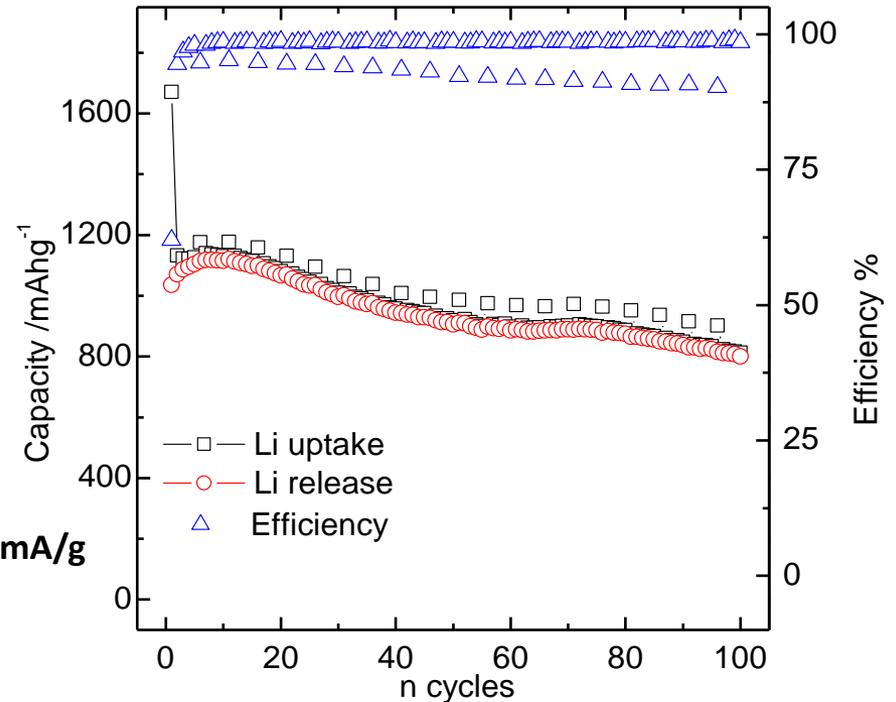
L'additivo Vinilen Carbonato (VC) forma un 'pre-strato di passivazione' che stabilizza l'interfaccia → **miglioramento in termini di stabilità**
