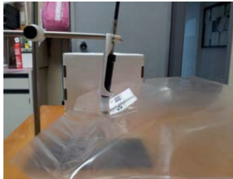
Campionamento dei VOCs emessi dalle pesche mediante Solid Phase Micro-Extraction, SPME.
