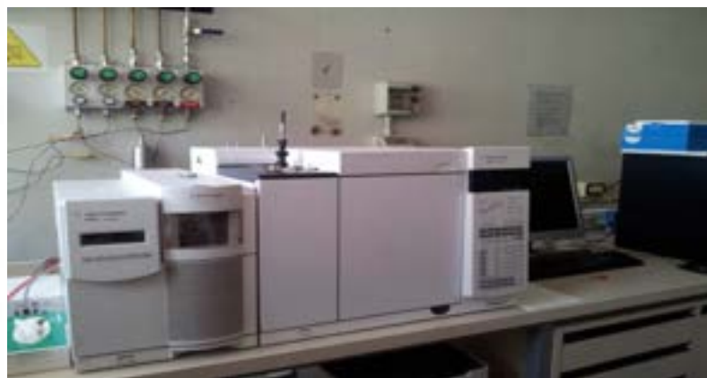
Spettrometro di massa accoppiato al Gascromatografo.
