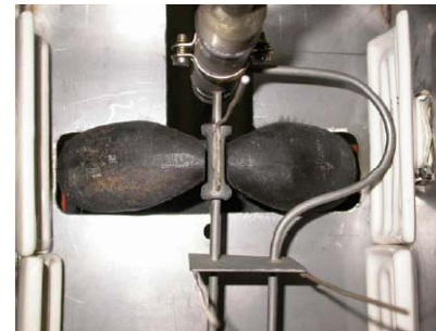
Misuratore di impurezza del litio (concentrazione N in Li) Resistivity Meter
