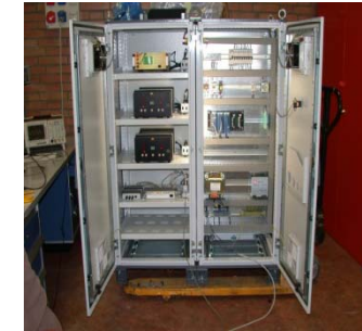
Armadio di controllo per il misuratore di impurezza del litio mediante rilevamento della resistività elettrica
