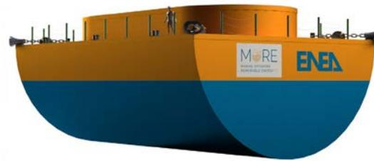
Render del PeWEC. Vista esterna. La linea di galleggiamento è evidenziata dalla separazione dei colori. Sono rappresentati in maniera schematica gli elementi di connessione dell'ormeggio sulla coperta che comprendono i fairlead e chaistopper e fissaggio della catena.
