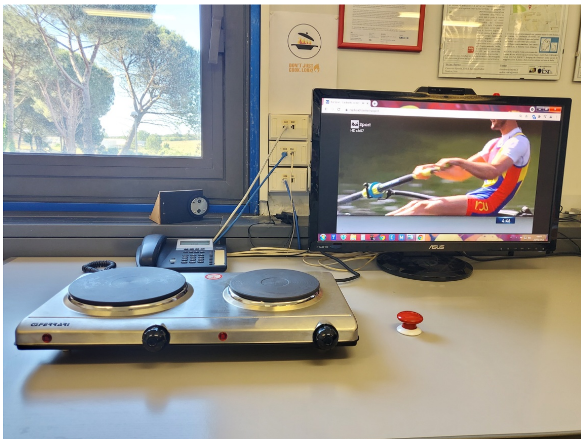
Figura 73. I fornelli elettrici in dotazione al Laboratorio collegati ad una presa intelligente con connettività wireless Z-Wave. Sulla destra il pulsante di ripristino, sempre con connettività wireless di tipo Z-Wave
