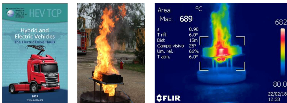
Figura 4 – Copertina del report IEA-HEV-TCP (sinistra); prove di partecipazione al fuoco di batterie al litio (centro e destra) [Cortesia: Corpo Nazionale Vigili del Fuoco]
