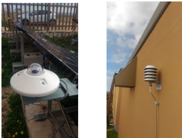
Figura 37. Il sensore di radiazione solare e di temperatura ambiente di nuova installazione
