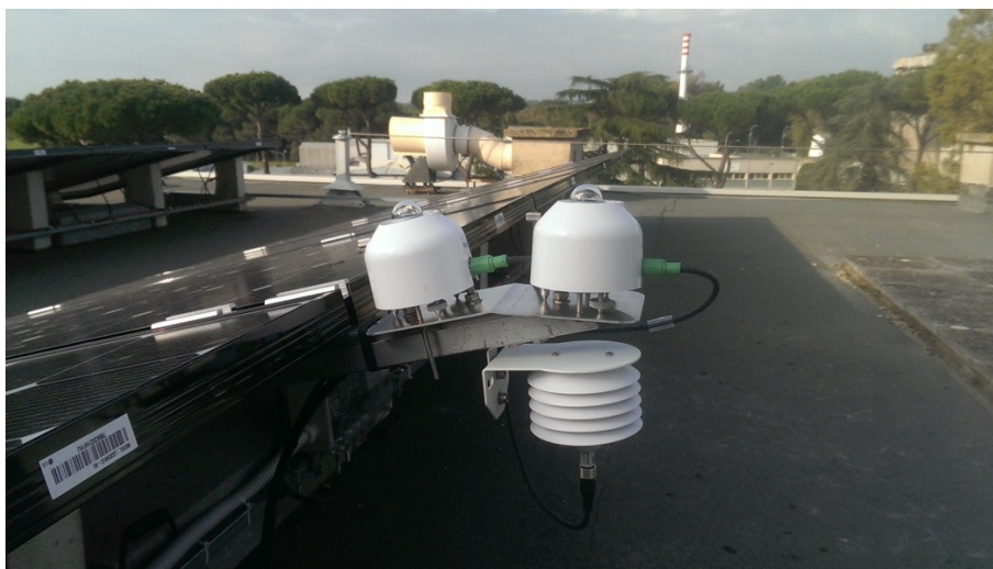
Figura 23. I sensori di radiazione solare e il sensore di temperatura e umidità relativa
