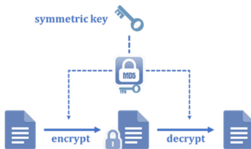
Fig. 11 - Schema di criptazione a chiave simmetrica e codice hash
