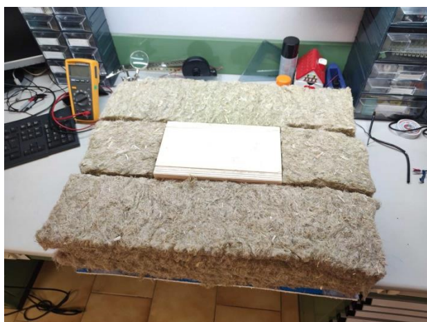
Figura 1: cornice isolata per le prove termiche.
