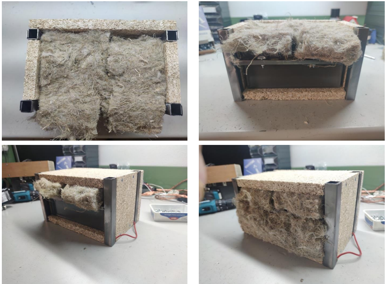
Figura 25: inserimento dell'isolante in fibra di canapa.
