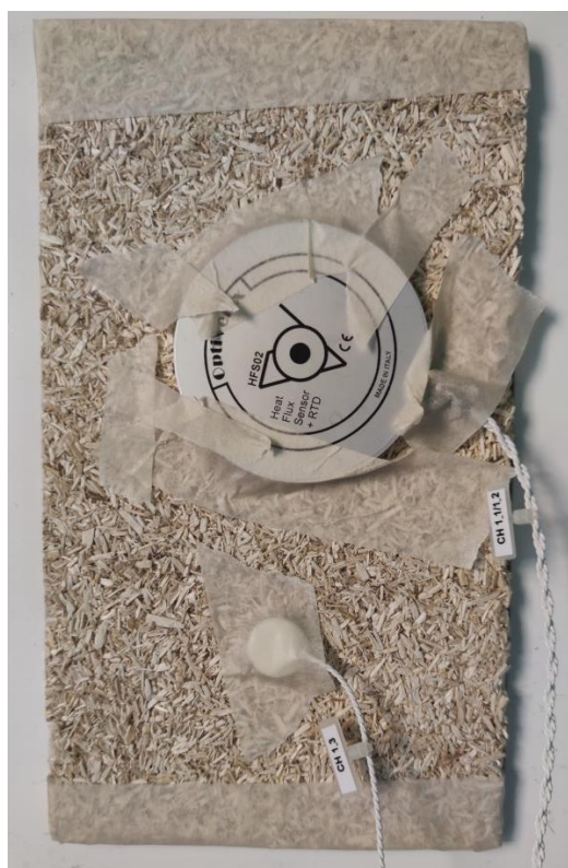
Figura 21: termoflussimetro applicato al provino.
