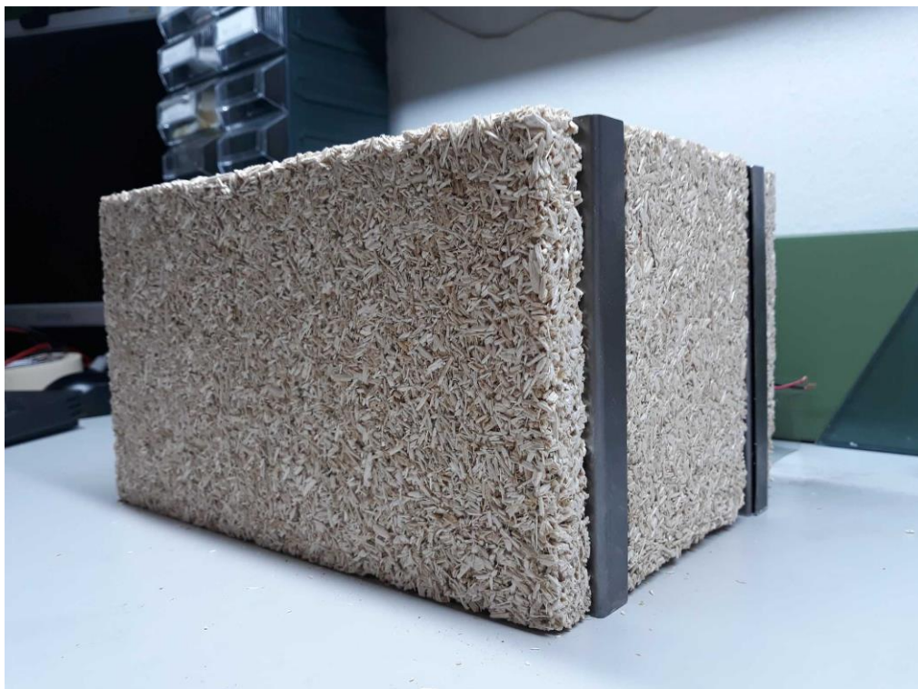
Figura 9: mattone completo realizzato in fibra di canapa.
