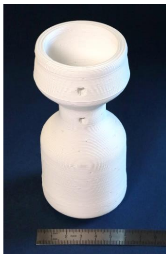
Figura 83. Gassificatore ceramico prima della sinterizzazione, ottenuto da stampa 3D con la pasta di tialite Zircomet sviluppata da ENEA
