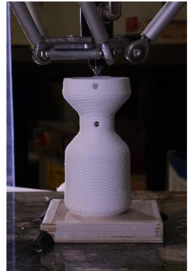
Figura 82. Alcune immagini acquisite durante la fase di stampa 3D del gassificatore ceramico con la pasta di tialite Zircomet sviluppata da ENEA
