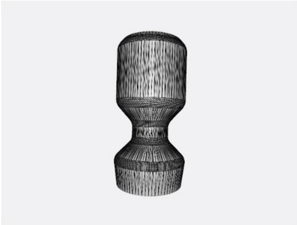
Figura 54. File STL del componente dimostrativo ceramico (gassificatore)
