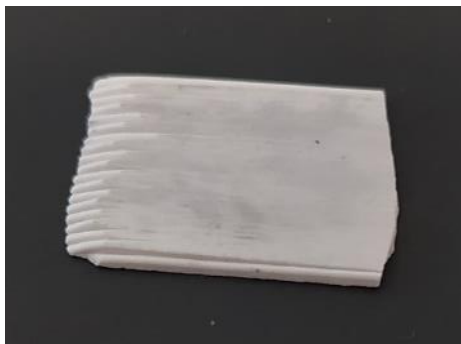
Figura 22. Campione Zircomet da stampa LDM dopo sinterizzazione per osservazione SEM
