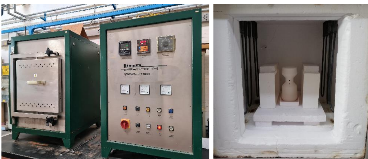
Figura 85. Gassificatore in forno Linn HT 1600 G per la sinterizzazione in aria a 1500°C
