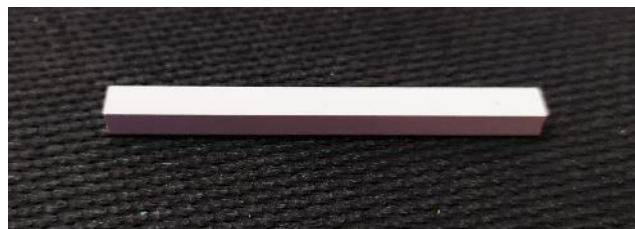
Figura 31. Campione Zircomet da pressatura convenzionale dopo sinterizzazione per osservazione SEM
