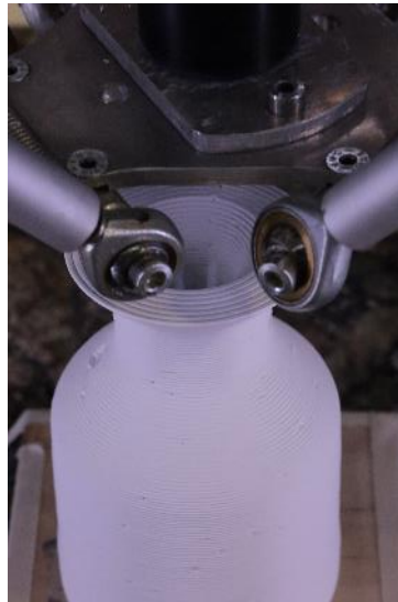
Figura 82. Alcune immagini acquisite durante la fase di stampa 3D del gassificatore ceramico con la pasta di tialite Zircomet sviluppata da ENEA
