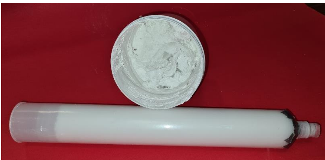
Figura 79. Pasta ceramica preparata per la stampa dell'alluminio titanato in verde con polvere Zircomet (Output LA 3.3 per LA 4.6) [10]
