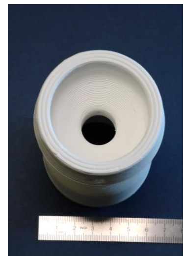
Figura 83. Gassificatore ceramico prima della sinterizzazione, ottenuto da stampa 3D con la pasta di tialite Zircomet sviluppata da ENEA
