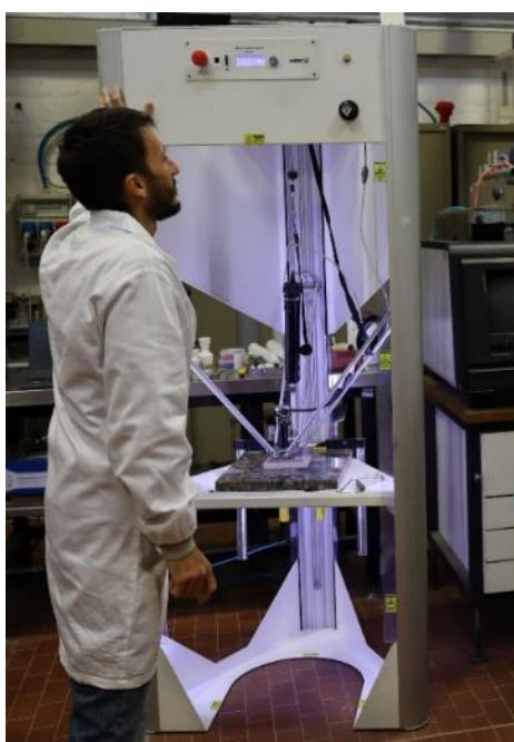
Figura 73. Stampante 3D Delta 40100 Clay – WASP installata presso i Laboratori ENEA di Faenza
