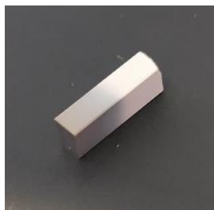
Figura 27. Campione Zircomet da stampa LDM dopo sinterizzazione per osservazione SEM della sezione
