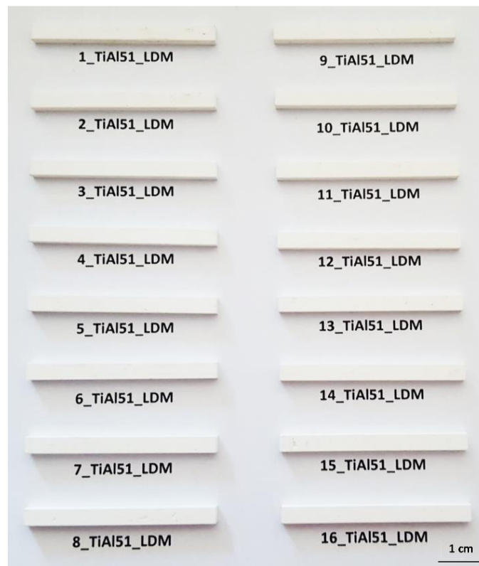
Figura 10. Provini di tialite Thermograde da stampa 3D sinterizzati [9]
