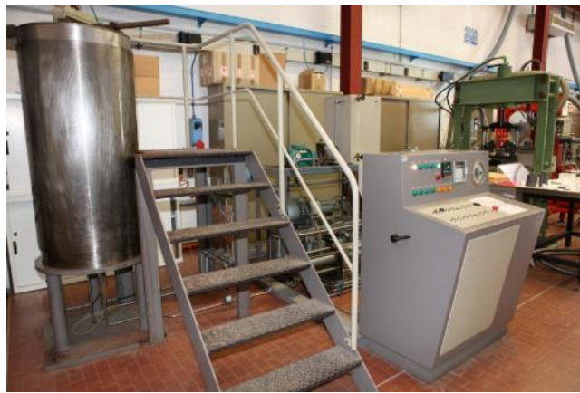
Figura 5. Pressa assiale (a) e pressa isostatica a freddo (b)
