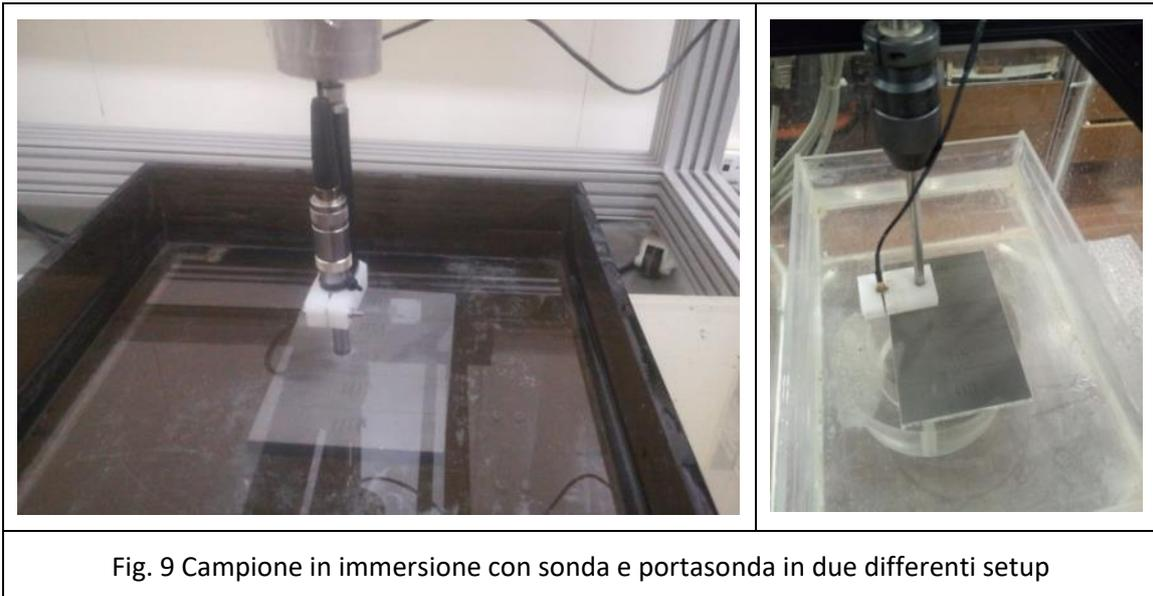
Fig. 9 Campione in immersione con sonda e portasonda in due differenti setup
