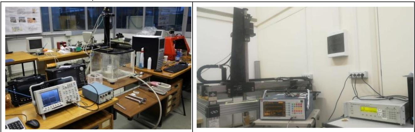
Fig. 4 sistemi di acquisizione per la mappatura ultrasonora
