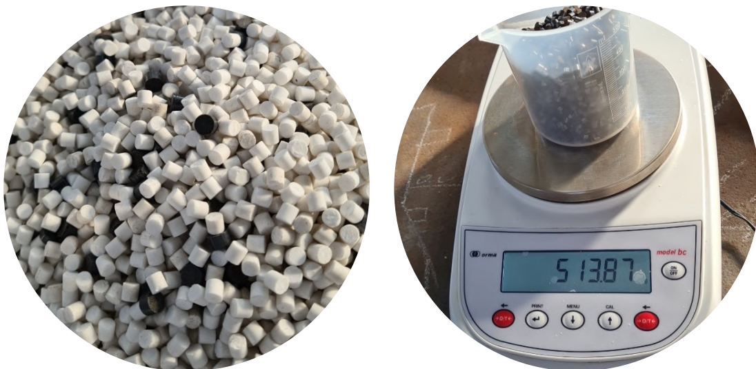
Figura 5.26. Pesata del catalizzatore idrogenante (sinistra) e preparazione della miscela catalitica con il materiale inerte (destra).
