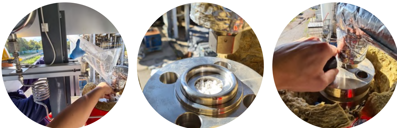
Figura 5.27. Procedura di caricamento della miscela catalitica all'interno del reattore monotubolare.
