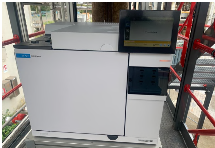
Figura 5.28. Gas-cromatografo per l'analisi delle specie fluide.
