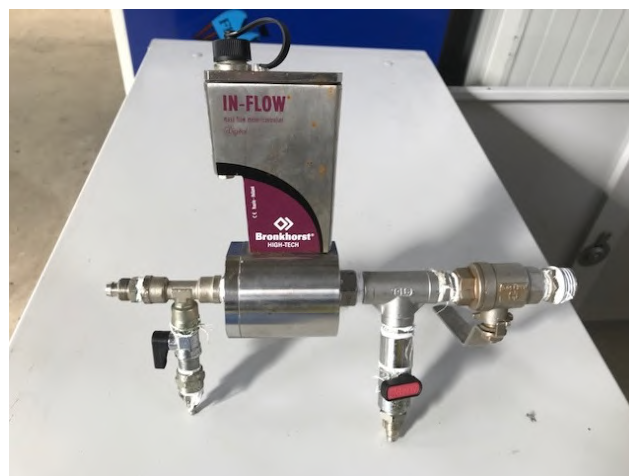
Figura 2.19. Misuratore massico della CO 2 desorbita.
