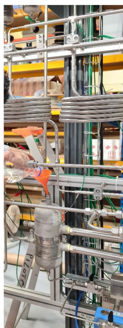
Figura 5.8. Introduzione di acqua nella trappola cere per l'attivazione degli interruttori di livello.
