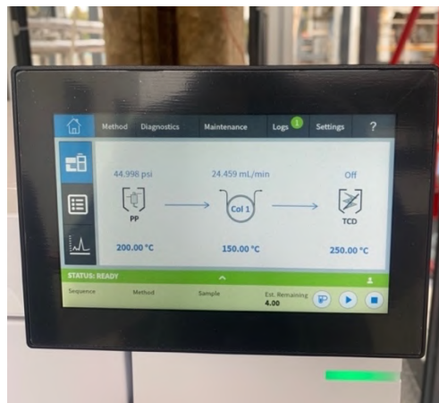
Figura 5.31. Pannello frontale GC con indicate le informazioni sullo stato dello strumento e delle colonne analitiche.
