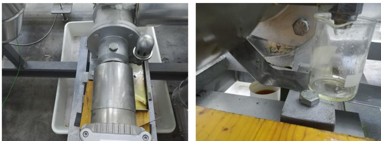
Figura 2-11: particolari che mostrano la perdita di olio riscontrato nel pompa GPTA40, usata per i test del 2019.
