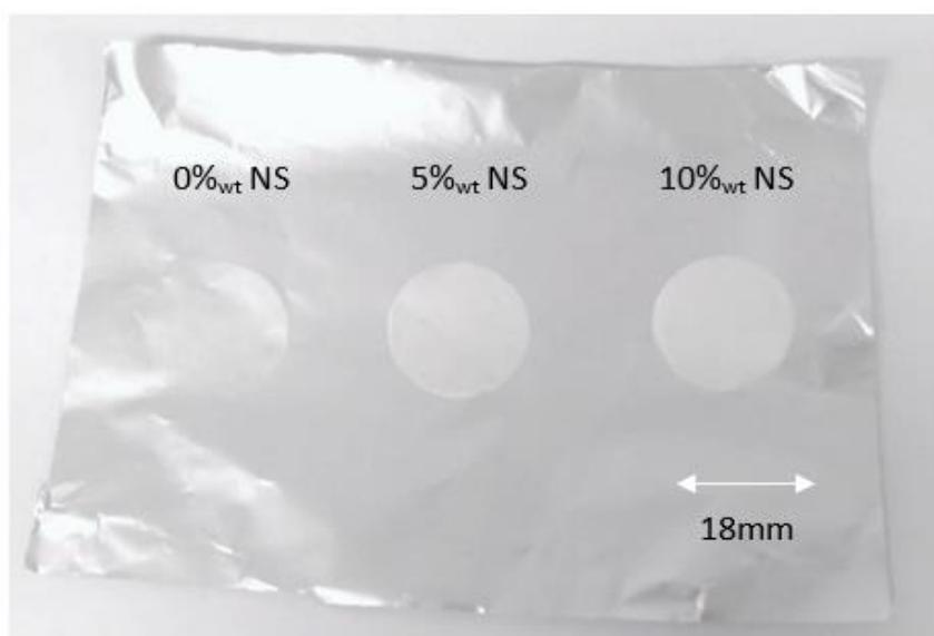
Figura 9. Aspetto delle membrane sintetizzate.
