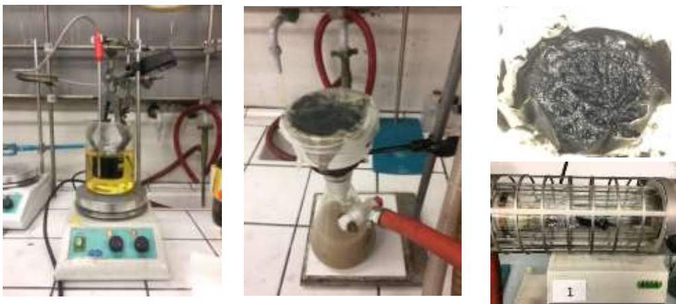
Figura 12. Fasi della preparazione del composto S/C: a) mescolamento, b e c) filtrazione e d) asciugatura
