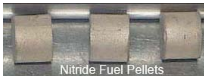
Figura 19. Pasticche di combustibile a nitruro
