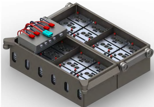
Figura 21. Rappresentazione tridimensionale del sistema batterie composto da 24 moduli 12 V – 60 Ah ed alloggiato nei due vani porta batterie
