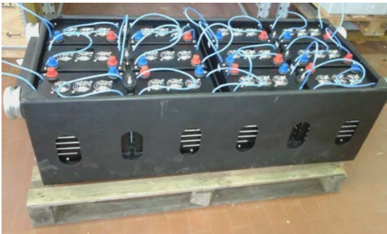
Figura 23. Vano porta batteria completo di moduli
