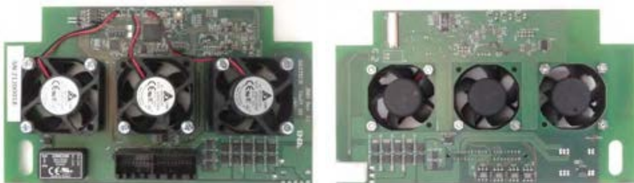
Figura 10. Scheda elettronica BMS, lato inferiore (destra) e lato superiore (sinistra)
