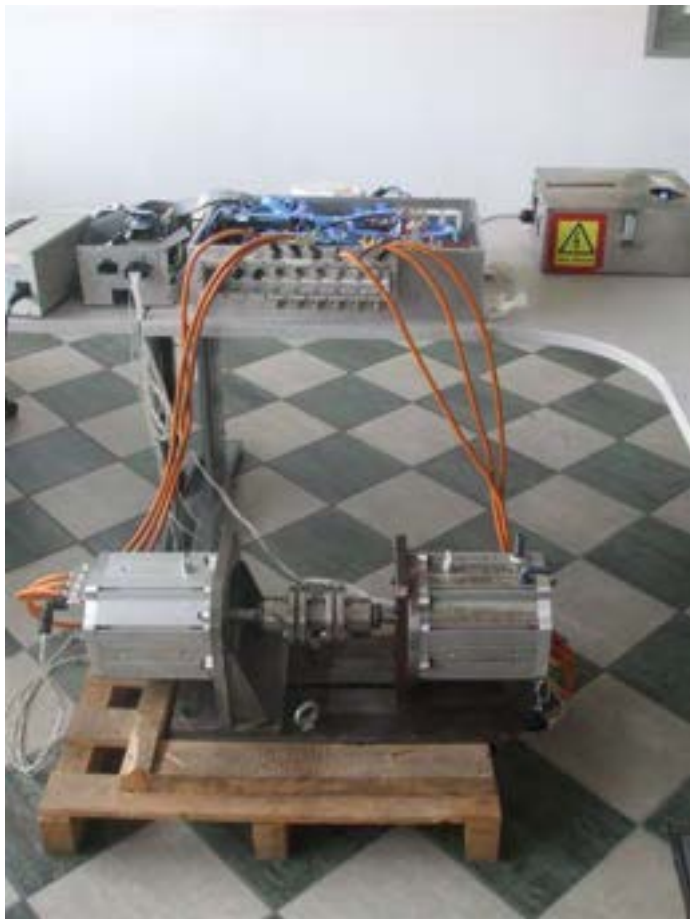
Figura 2 . test con i due motori
