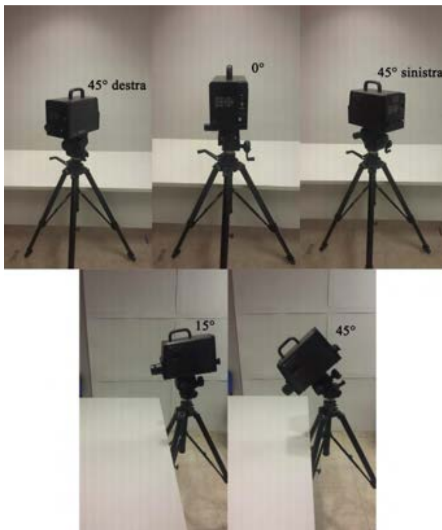
Figura 4. Angoli di inclinazione dello spettroradiometro utilizzati per le misure a livello degli occhi
