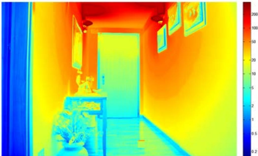
**Figura 57 - Misura di luminanza dell'ingresso con le appliques al massimo dell'intensità luminosa (il valore massimo in corrispondenza della sorgente è stato saturato a 200 cd/m<sup>2</sup>)**
