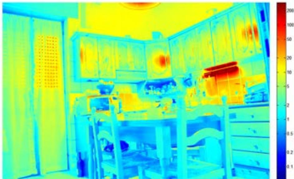
**Figura 53 - Misura di luminanza della cucina con il punto luce centrale acceso e l'illuminazione del sottopensile (il valore massimo in corrispondenza della sorgente è stato saturato a 200 cd/m<sup>2</sup>)**
