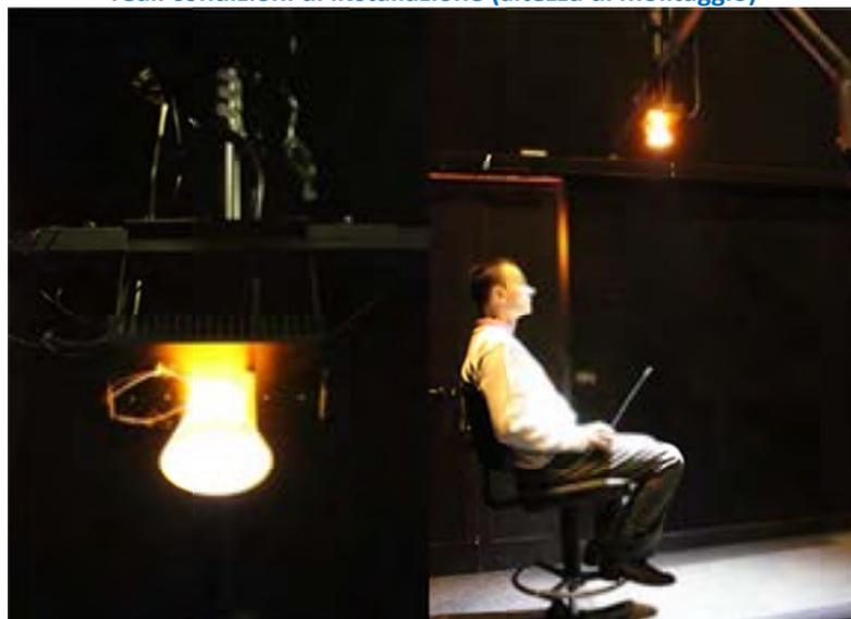
**Figura 124** Verifica sperimentale dell'efficacia della schermatura meccanica nelle condizioni di installazione
