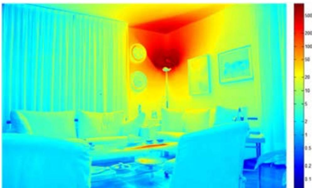
**Figura 58 - Misura di luminanza del salotto da una vista frontale con il punto luce indiretto acceso (il valore massimo in corrispondenza della sorgente è stato saturato a 500 cd/m<sup>2</sup>)**
