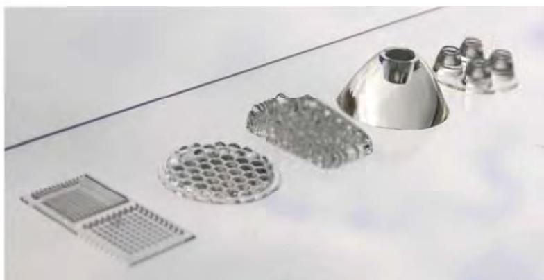
**Figura 116 Prototipazione rapida di sistemi ottici**
