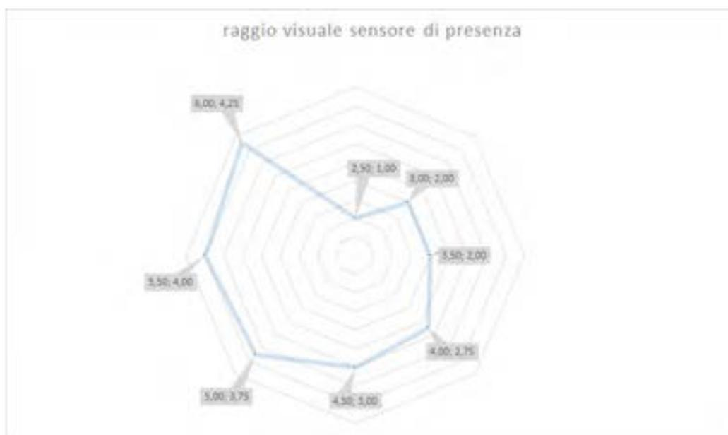
**Figura 27: Relazione tra altezza dello strumento e raggio visivo di lettura**
