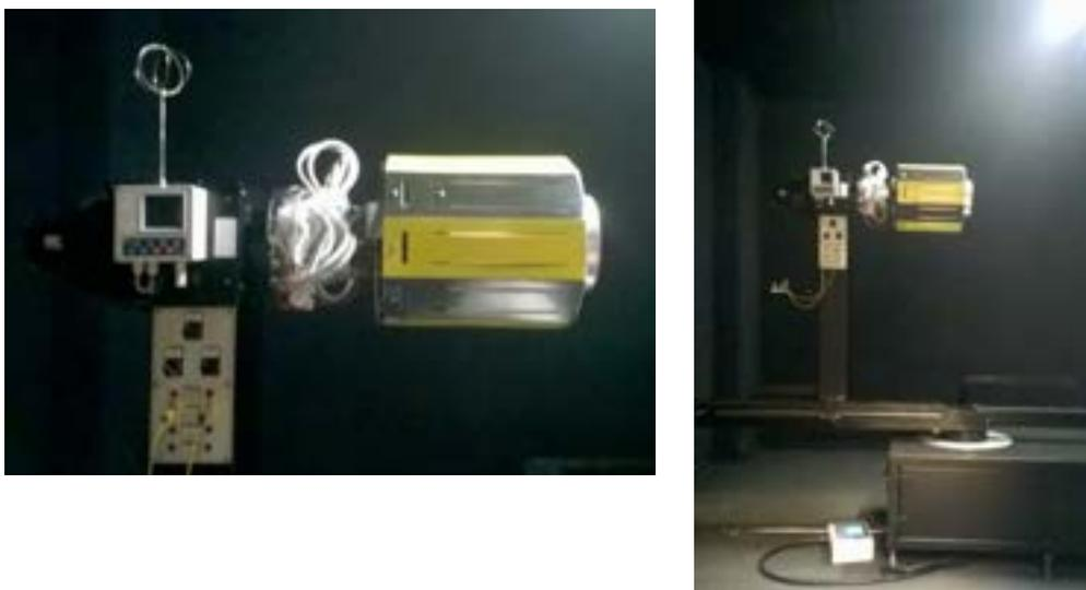
**Figura 17: Misura nel goniometro della Oxytech**
