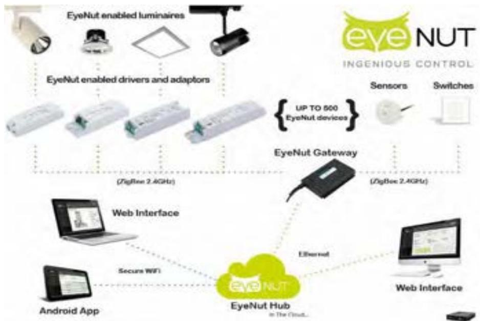
Figura 5: Infrastrutture del sistema EyeNut (EyeNut manual)
