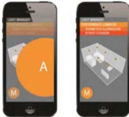
Figura 65 Interfaccia di controllo SUI per smart phone con limitazione al solo controllo delle performance luminose
