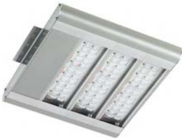
Figura 11 Esempio di apparecchio modulare a LED per illuminazione industriale LANZINI: l'unità atomica del sistema è il modulo (stagno) che contiene 20 LED equipaggiabili con differenti tipi di ottiche. Il numero di moduli dipende dal flusso luminoso richiesto dall'applicazione
