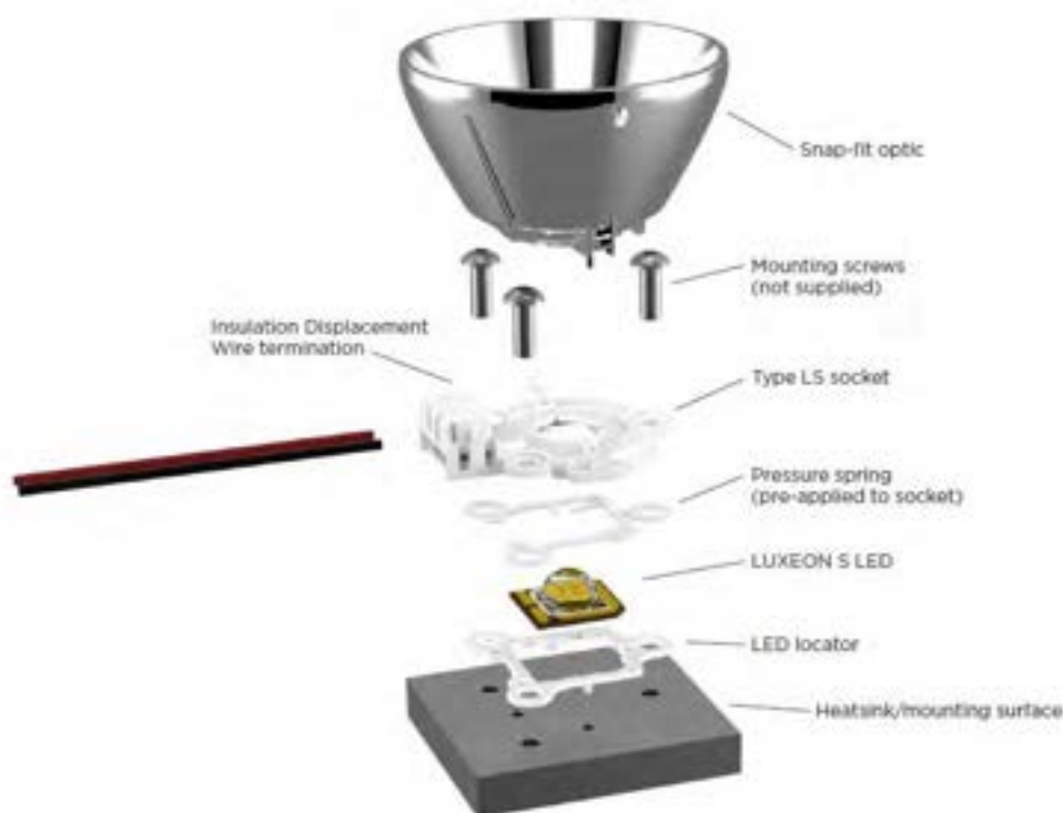
Figura 152 Soluzione alternativa del prototipo 2, dove la lente TIR è stata sostituita da un riflettore e da un diffusore olografico
