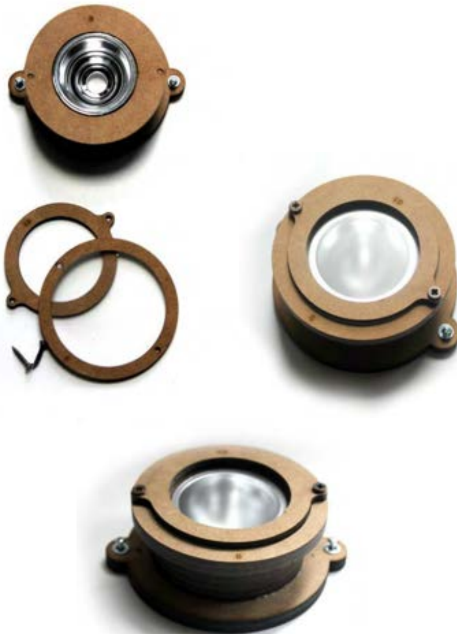
Figura 154 Sistema ottico per la Soluzione 03: riflettore Venla e diffusore olografico Luminix ( 10^\circ )
