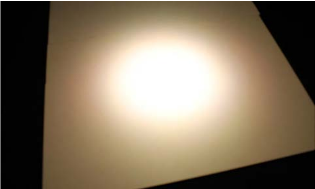
Figura 178 Soluzione 03 con miscelatore LEDIL e riflettore LEDIL ANGELA-S
