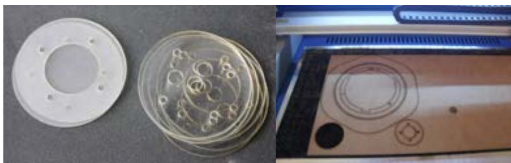
Figura 110 Immagini che mostrano l'attività di prototipazione mediante taglio laser
