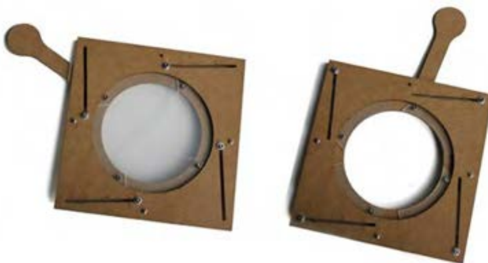
Figura 161 Sistema ottico per la modificazione dell'ampiezza del fascio di luce per la Soluzione 04: diaframma costruito mediante taglio laser del diffusore olografico Luminit (80°)
