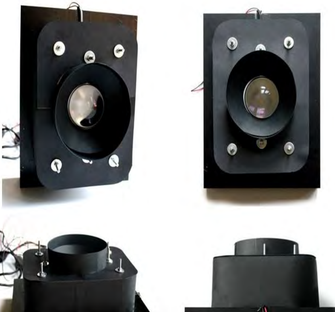
Figura 133 Soluzione 01: prototipo utilizzato per le misure di flusso (sistema completo e di ciascun componente)
