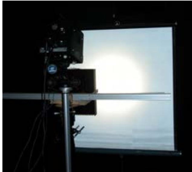
Figura 172 Setup per la valutazione cromatica dell'emissione luminosa su uno schermo
