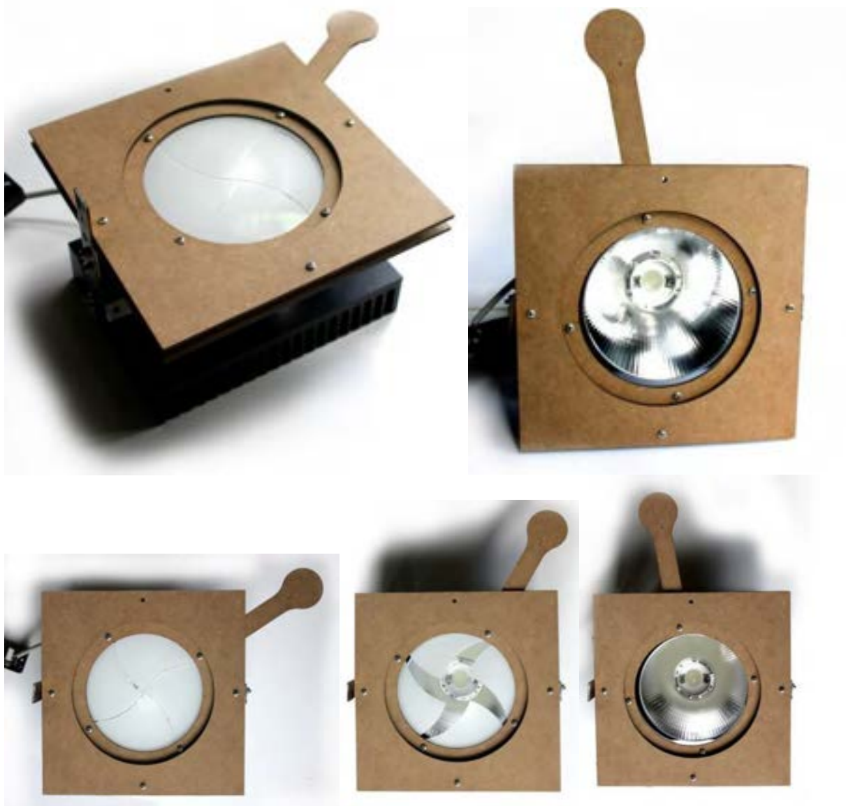
Figura 163 Soluzione 04: prototipo utilizzato per le misure di flusso (sistema completo e di ciascun componente) considerando le diverse posizioni del diaframma
