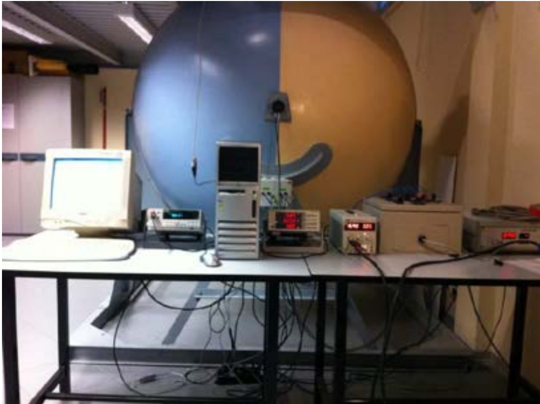
Figura 101 – Sfera integratrice per le misurazioni dei flussi in funzione delle correnti di pilotaggio.
