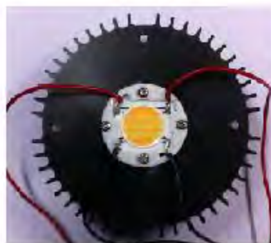
Figura 92 Sharp Tiger Zenigata : nella figura si vede la disposizione alterata dei fosfori che consentono di ottenere due differenti temperature di colore (bianco caldo a 2700K e freddo a 5700K). A sinistra un esemplare del dispositivo, montato su dissipatore passivo, utilizzato per le misure spettrali utilizzate nelle diverse elaborazioni
