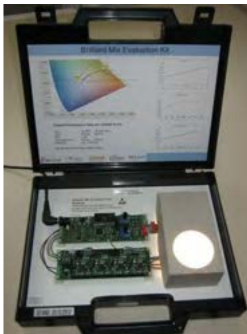
Figura 83 Demo kit Brialliant mix utilizzato per le valutazioni di efficienza ottica di radiazione e resa cromatica
