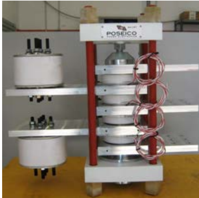
Figura 4 – Vista frontale del CS1 power assembly.
