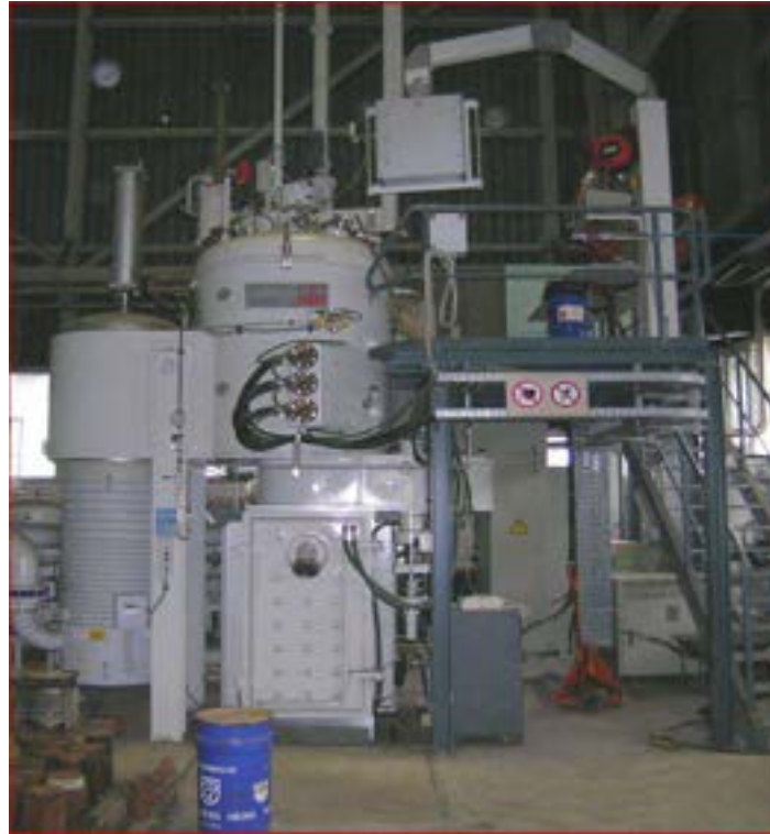
Fig. 2 – Impianto VIM (ALD-Vacuum Technologies) presso il CSM
