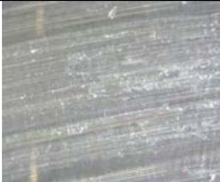
Superficie di Pb cristallizzato
