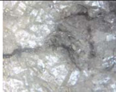
Superficie di Pb cristallizzato
