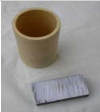
Panetto di Pb e crogiolino in allumina
