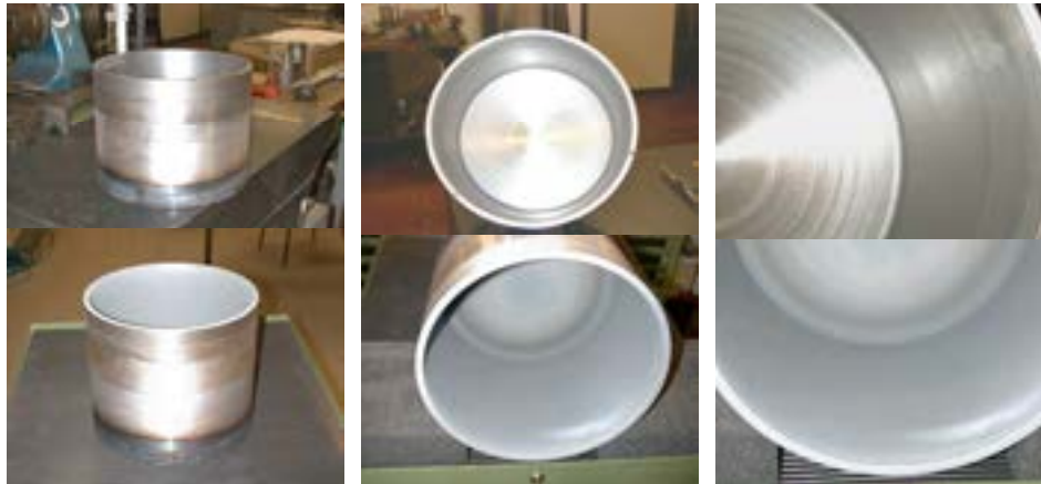
Figura 13 – Protezione del crogiolo del Pyrel II mediante rivestimento protettivo interno: le foto mostrano il crogiolo in acciaio ferritico prima (sopra) e dopo (sotto) l'applicazione del rivestimento
