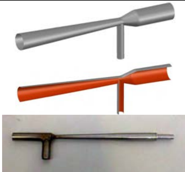
Tubo Venturi (sotto) con disegni di progetto (sopra)
