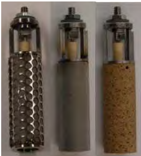
Figura 4. Cestelli catodici in acciaio (a sinistra), acciaio sinterizzato (al centro) e magnesia porosa (a destra)
