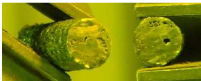
Figura 6. Sezione del cestello catodico al termine dell'elettroreduzione di UO_2
