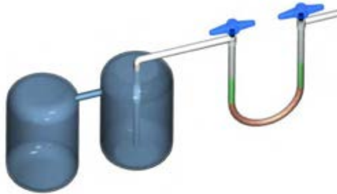
Figura 33. Schema dell'apparato sperimentale per evidenziare la presenza di cloro, ossigeno, o anidride carbonica in una corrente di argon che fuoriesce dalla scatola a guanti: il gas passa inizialmente attraverso un tubo ad U contenente gel di silice (avente lo scopo di evitare l'ingresso di umidità nella scatola a guanti), quindi in due bottiglie Drechsel poste in serie e contenenti soluzioni idonee a rivelare la presenza dei suddetti gas.
