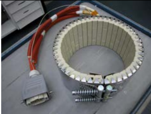
Figura 38. Sistema di riscaldamento dell'impianto Pyrel III
