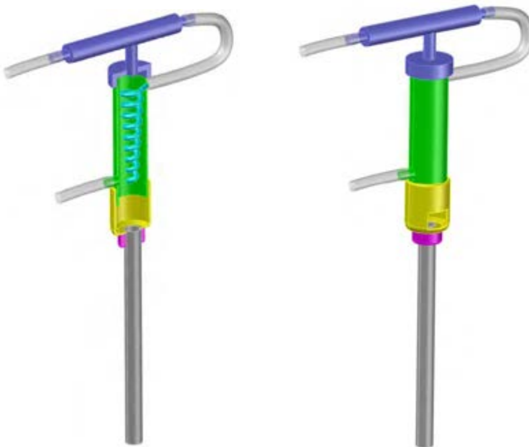
Figura 31. Schema di progetto del sistema di “ gas trapping ” per l’aspirazione ed il trasferimento dei gas sviluppati nella cella elettrolitica
