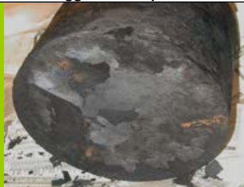
Dettaglio della corrosione esterna
