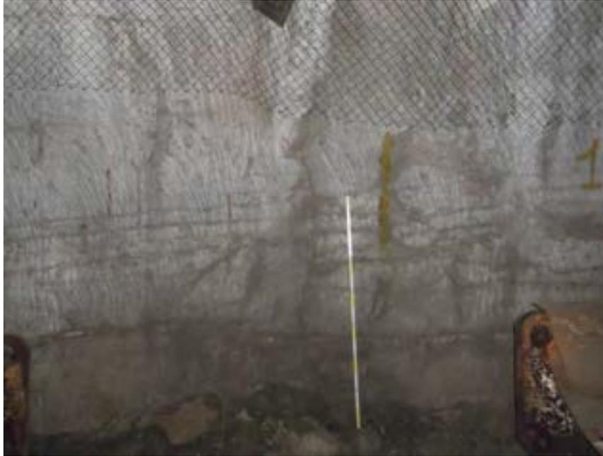
**Figura 7– Sistema di faglie a basso angolo. Notare la variazione di spessore tra il tetto e il letto delle faglie.**
