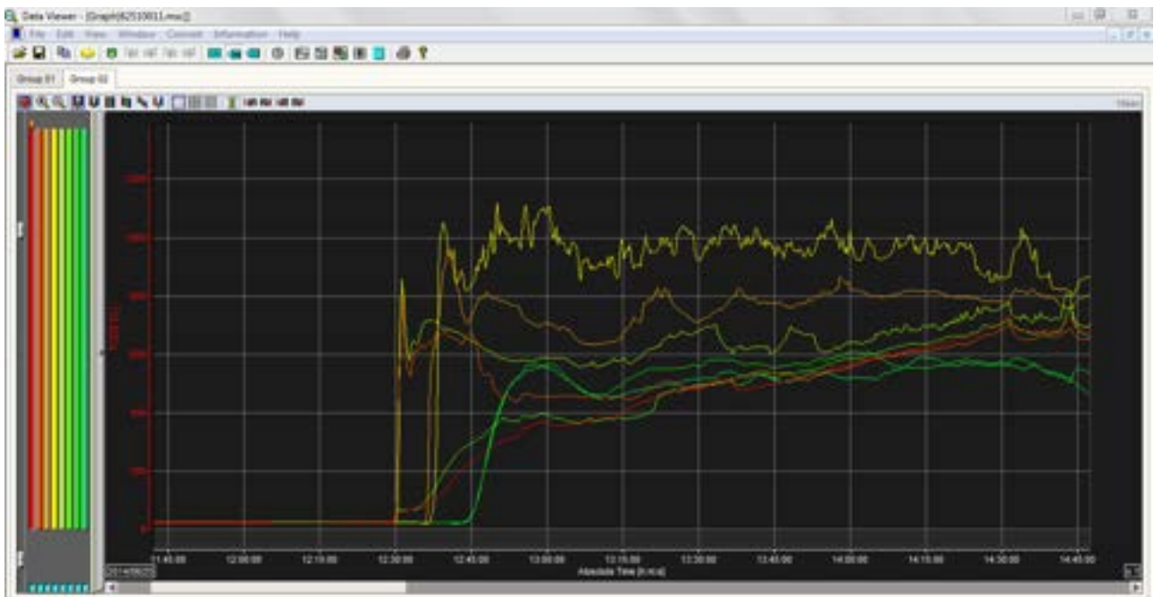
Figura 13. Andamento delle temperatura interne in avviamento test 25/06/2014
