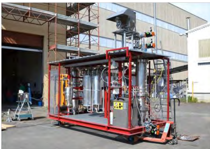
Figura 1: Impianto di produzione di gas sintetico GESSYCA
