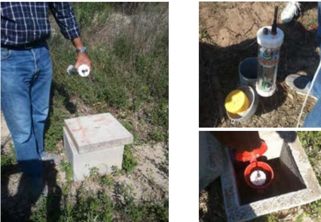
Figura 9. Posizionamento delle sonde nei piezometri.
