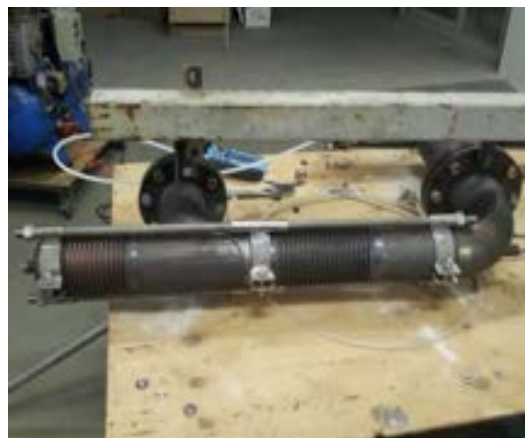
Figura 8. Test di tenuta del cross-piping dopo la riconfigurazione.
