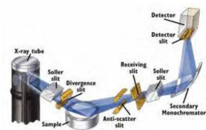
Figura 4. Caratteristiche ottiche del diffrattometro
