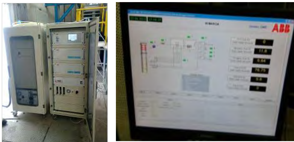
Figura 3.5: Sistema di acquisizione della composizione del gas
