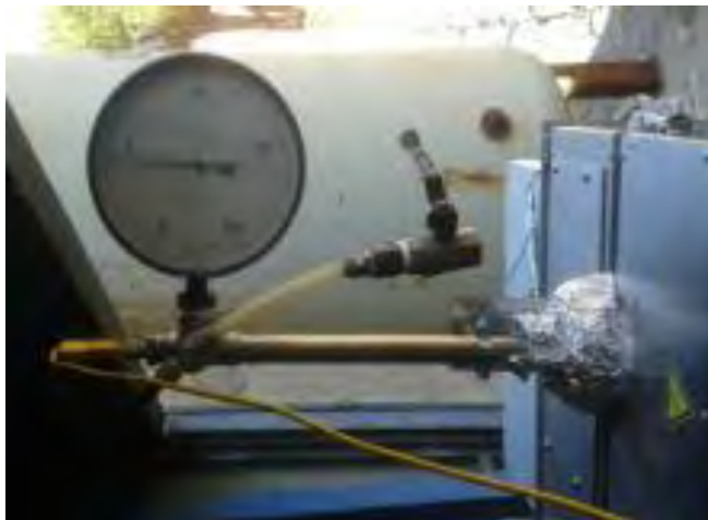
Figura 3.6: Manometro e controllo dei flussi inviati
