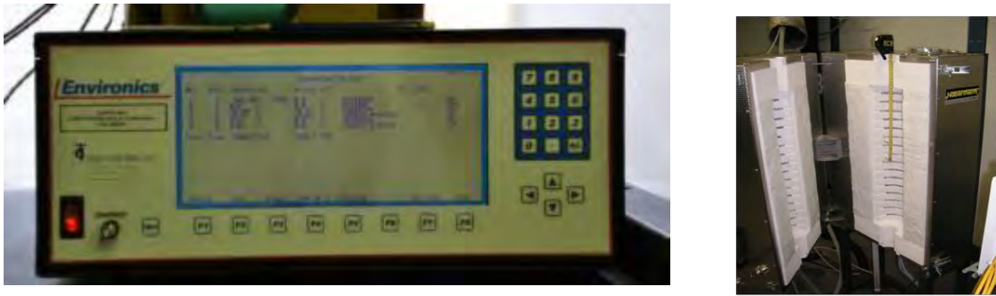
Figura 3.2. mixer e forno di alloggiamento del reattore
