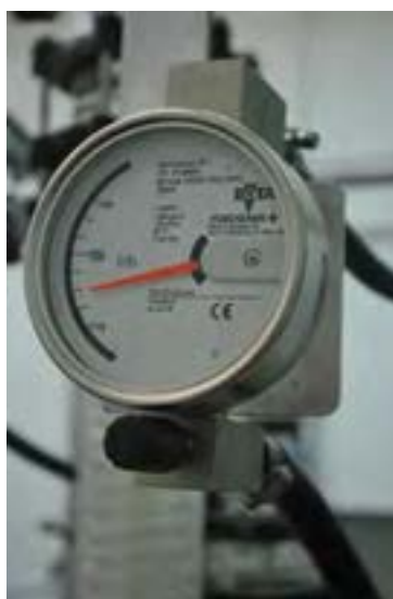
Figura 15-10. Particolare del sistema di misura e regolazione della portata di solvente.
