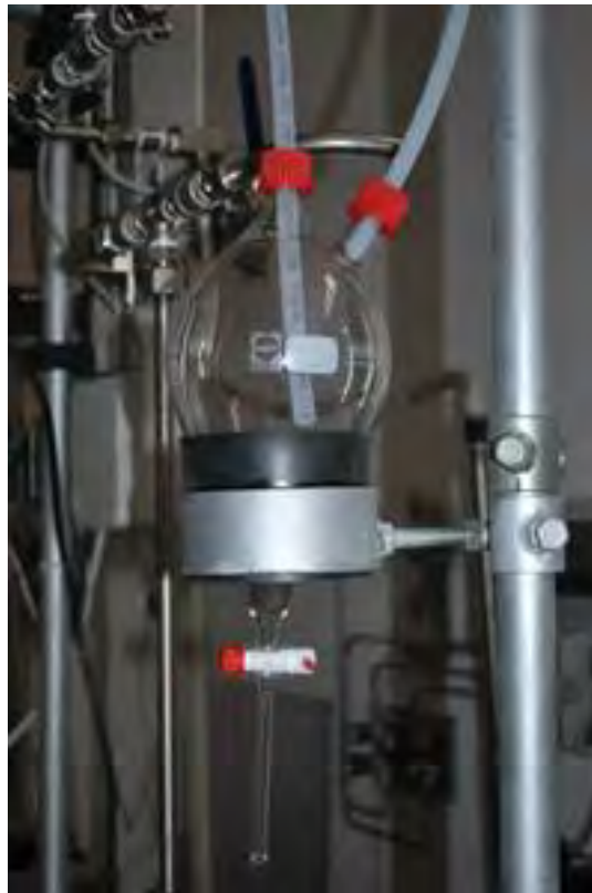
Figura 15-15. Sistema di separazione e scarico della condensa.
