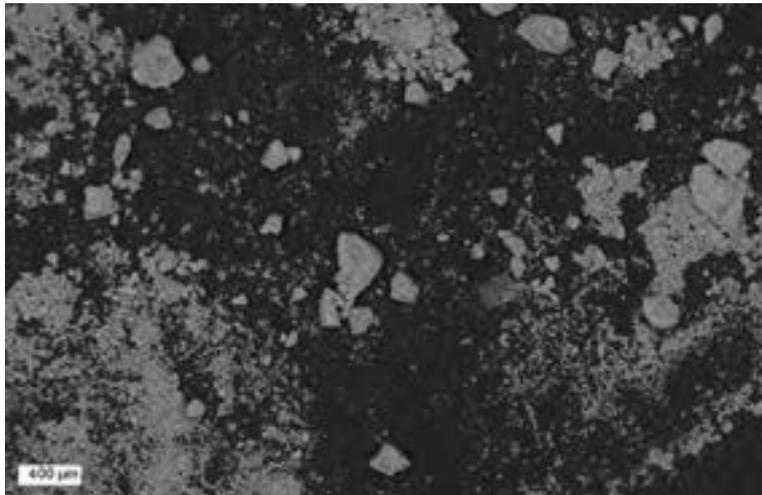
Figura 3- G1-85: gli elementi presenti sono Ni, Al, O, Zr; la granulometria delle particelle è eterogenea, da decine di nm a centinaia di  $\mu\text{m}$ ; Film del catalizzatore omogeneo con spot bianchi relativi a Zr.
