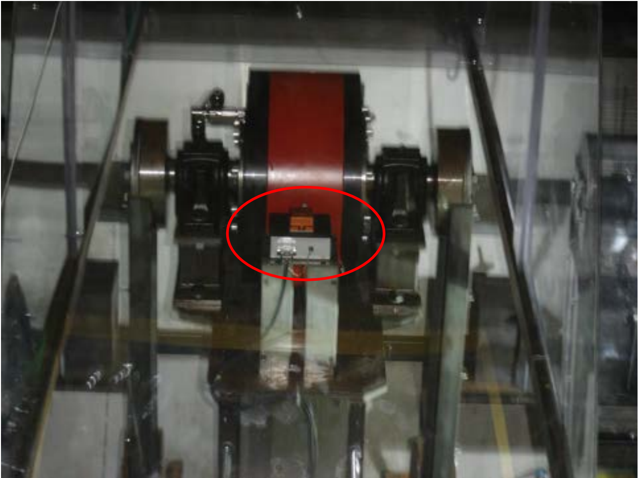
Figura 17 – Posizionamento del sensore MTi all'interno dello scafo
