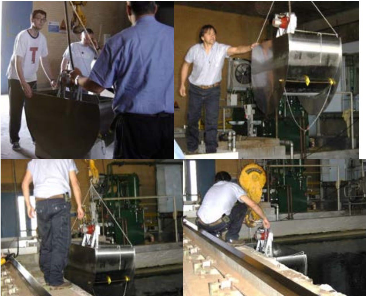
Figura 6 – Varo del prototipo nel bacino
