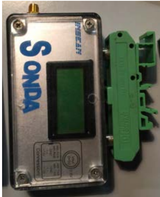
Figura 15 – Testa di misura della sonda capacitiva
