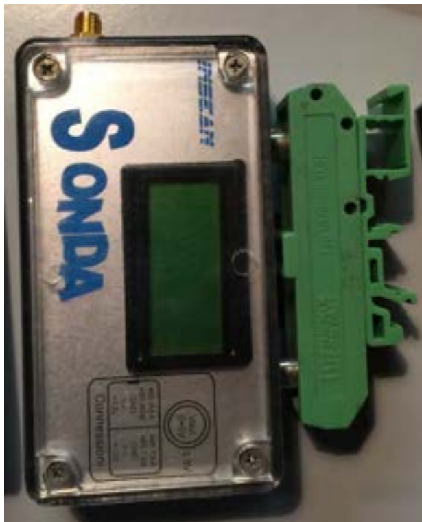
Figura 13 – Testa di misura della sonda capacitiva
