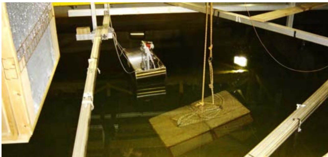
Figura 12 – Installazione del sistema di ormeggio (operazione di sollevamento e vincolo al corpo morto posto in fondo al bacino)
