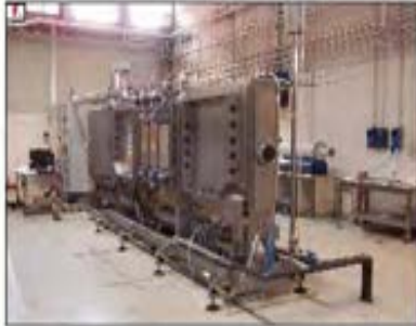
Apparato di sputtering per R&D su coating solari selettivi
