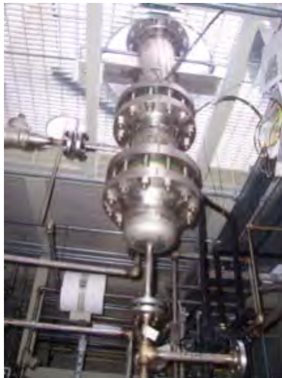
Figura 3. - reattore a membrana COMETHY durante la costruzione (ENEA).
