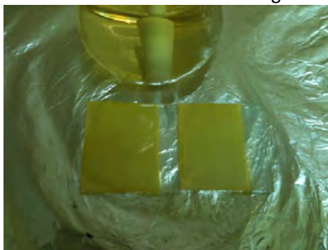
Figura 10. Foto digitale dei campioni dopo la deposizione tramite spin coating della soluzione \text{PbI}_2/\text{DMF}
