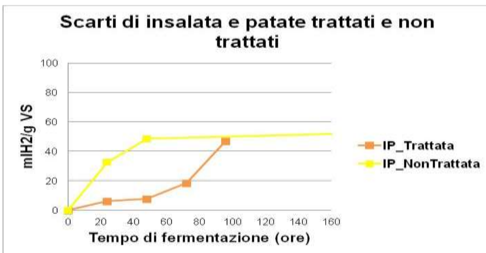
Figura 43. Curve di produzione (ml H 2 /g VS) di H 2 da scarti di insalata con patate trattati e non trattati termicamente
