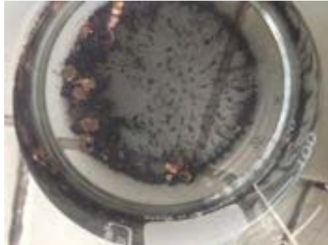
Figura 21. Immagine del nastro anodico dopo sonicazione (60% di ampiezza) in mezzo acquoso per 20min.
