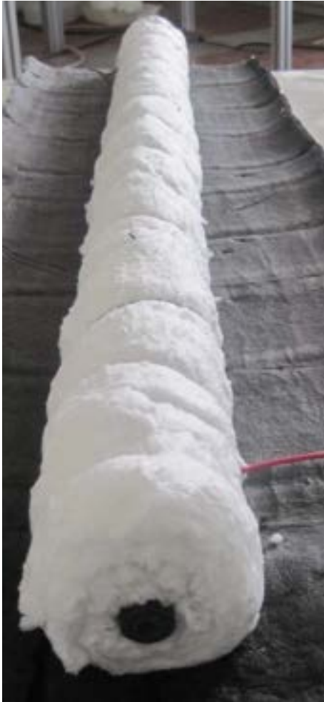
Figura 28-strato di fibra ceramica
