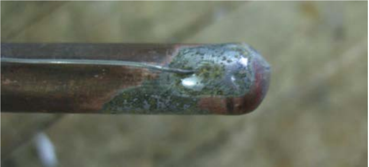
Figura 18-particolare della saldatura della termocoppia T cond sul condensatore
