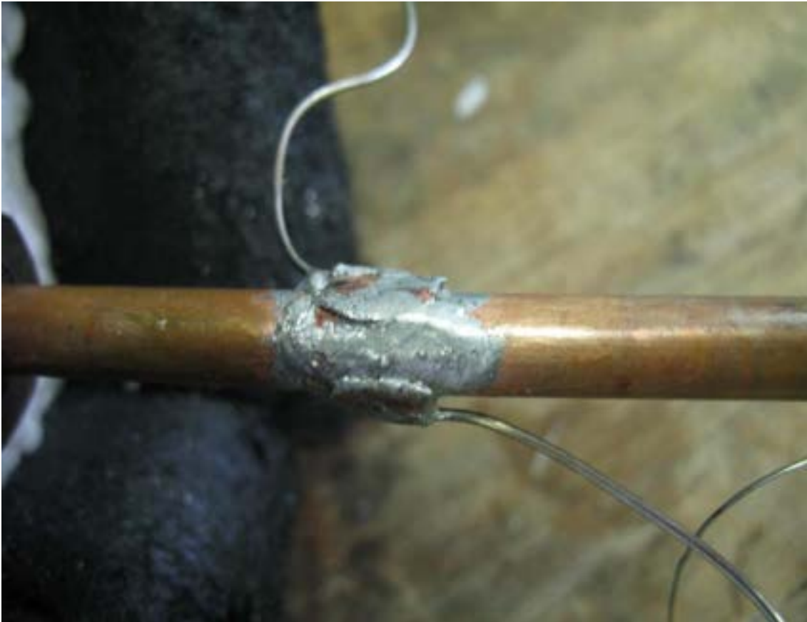
Figura 39-particolare delle termocoppie brasate sulla sezione adiabatrica
