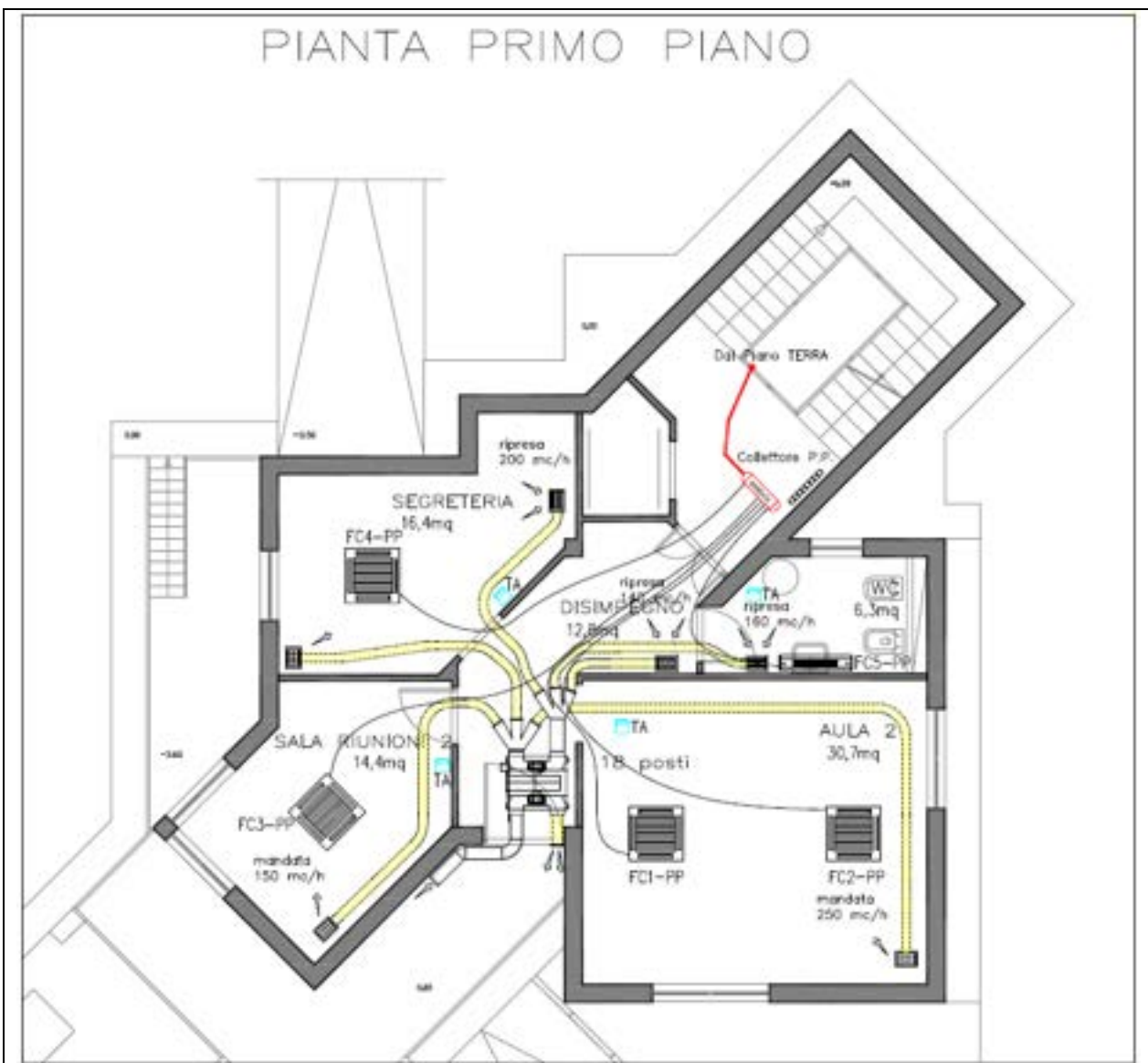
Fig. 3: Layout impianti piano primo
