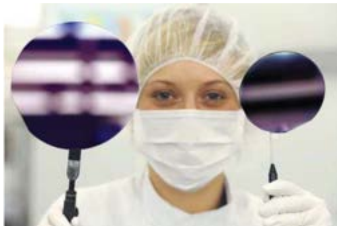
Figura 2.1. La Osram Opto Semiconductors è passata dai wafer da 4 pollici (a destra) a quelli da 6 pollici (a sinistra), aumentando la capacità produttiva e quindi abbattendo i costi.
