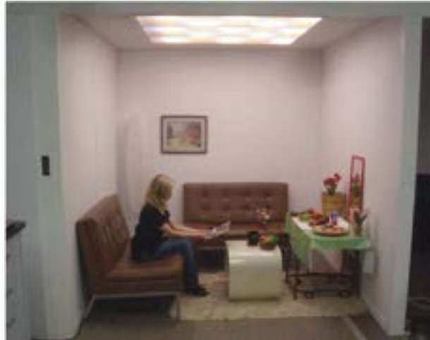
Figura 7.3. Il NIST ha un laboratorio con un apparecchio illuminante a spettro variabile a 22 canali di colore che consente ai ricercatori di indagare le potenzialità del CQS.
