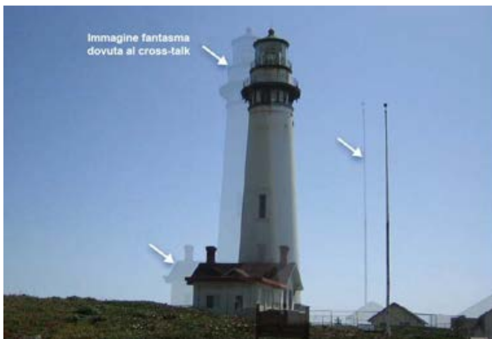
Figura 6.8. Immagine da televisore LED dove è evidente il fenomeno delle immagini fantasma dovute al cross-talk.
