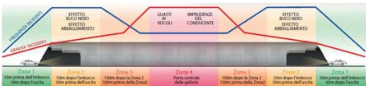
Figura A1.1. Suddivisione longitudinale della galleria per livelli di pericolosità
