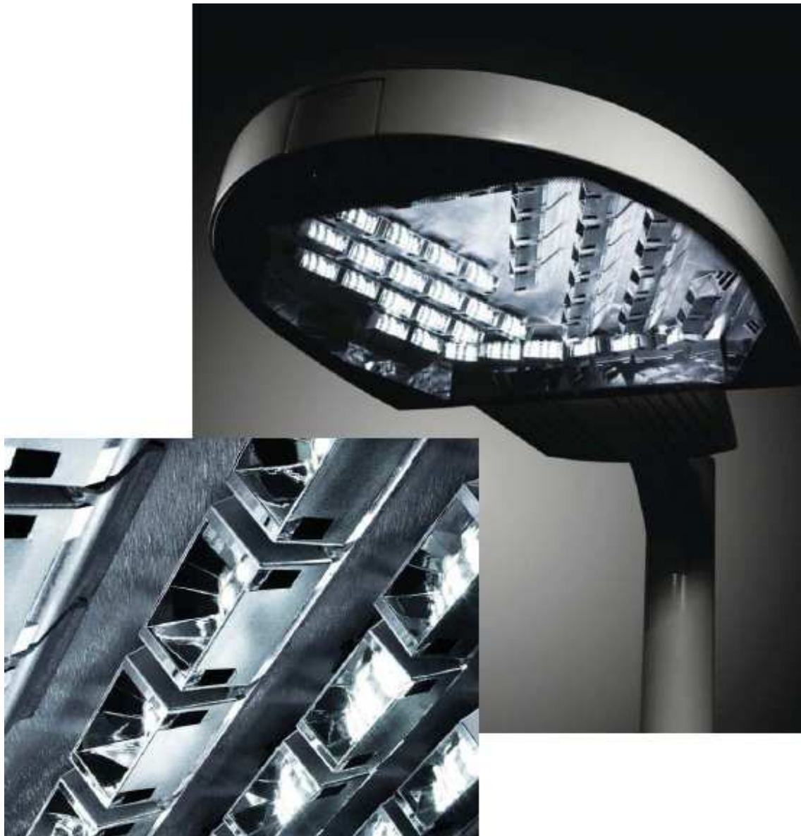
Figura 5.25. L'apparecchio Warp9 LED della Kim monta piccoli gruppi di LED all'interno di un modulo riflettore MicroEmitter che dirige la luce a un riflettore più ampio per formare il fascio luminoso desiderato.
