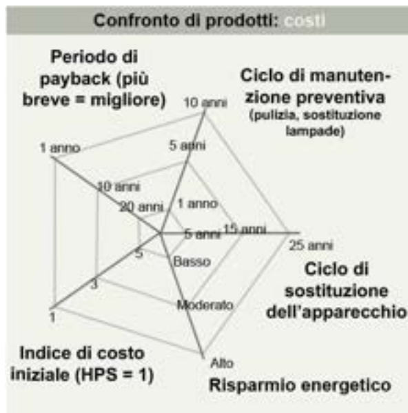
Figura 1.4. Due esempi di diagrammi a ragnatela: a) Confronto di diversi criteri di progettazione; b) Confronto di diversi criteri di costo
