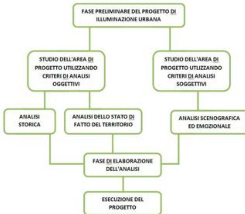
Figura 4.16 Schema metodologico per la realizzazione dell'illuminazione urbana
