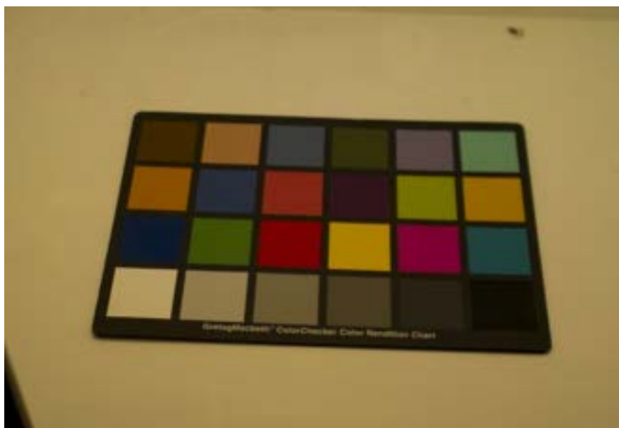
figura 9 color checker sotto lampada a filamento di tungsteno corretta per luce naturale con filtro blu
